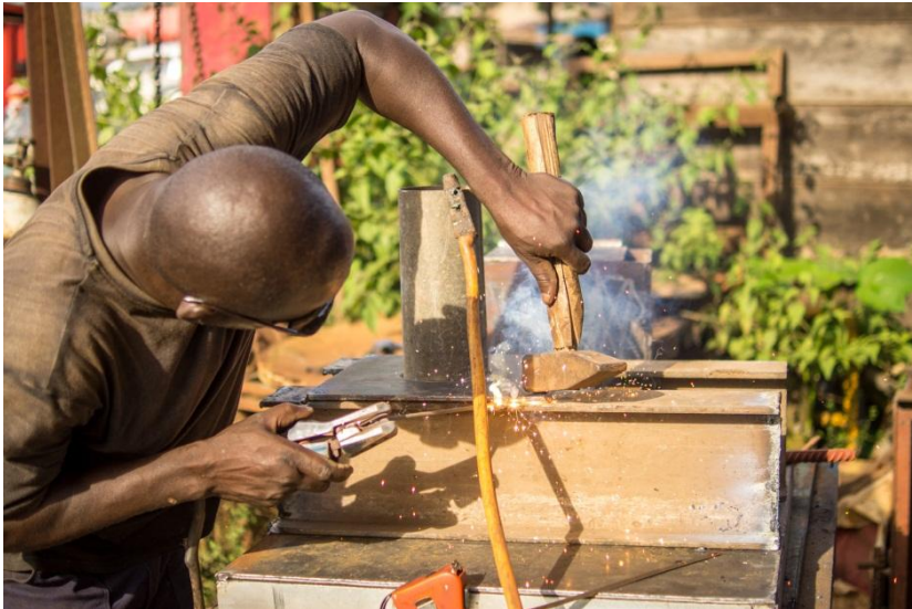
Schweißarbeiten für die Stahlteile des Ofens auf dem Stahlmarkt in Takoradi (links) und Aufstellen des Schornsteins am Waste Yard (rechts)
